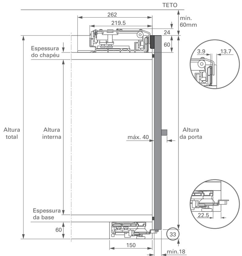
**Altura da porta = Altura interna + Espessura do chapéu + Espessura da base + 87**
