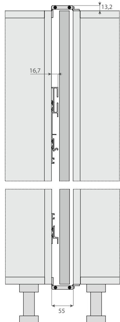
Fig. 1: Não é possível aplicar o tamponamento suspenso como mostrado na Fig. 1.
