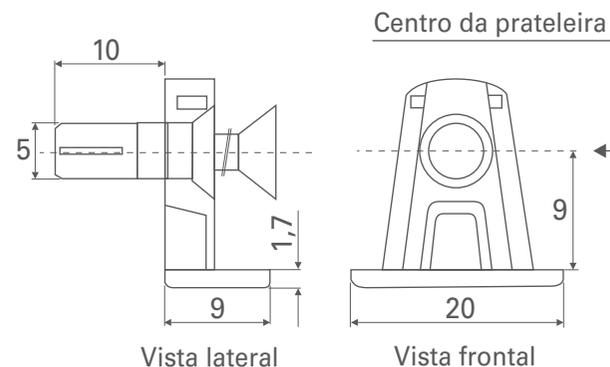
Apoio autobloqueador em metal com bucha plástica para painel de 18mm
