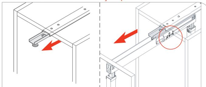
Extrair a correção encaixada na ferragem
