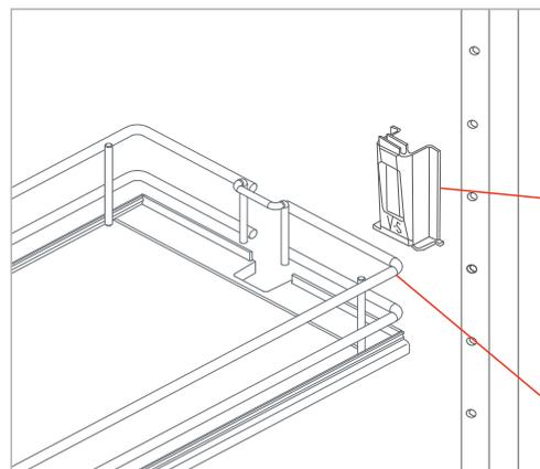
Posicionar os clips de fixação dos cestos na altura desejada.
