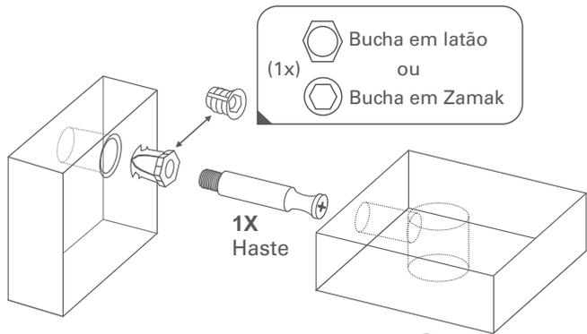
Encaixe os componentes conforme a imagem acima, em seguida aperte o parafuso pré montado para a fixação do sistema.
