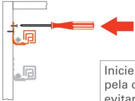
Inicie a montagem sempre pela corredeira superior para evitar que caia sujeira nas próximas a serem instaladas. **ATENÇÃO**
