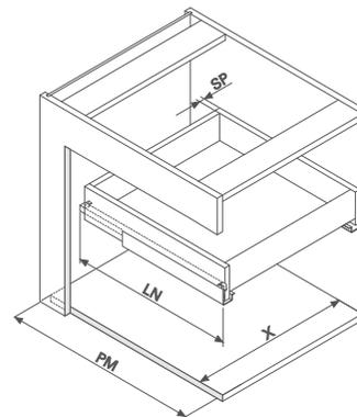
Posicionamento dos furos da corredeira para a fixação na lateral do móvel
