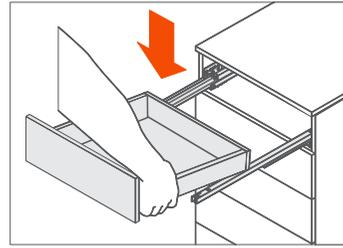
Extraia totalmente as duas corredeiras já instaladas no módulo. Posicione a gaveta já com os clips instalados, sobre as corredeiras.
