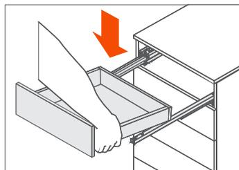
Extraia totalmente as duas corredejas já instaladas no módulo. Posicione a gaveta já com os clips instalados, sobre as corredejas.
