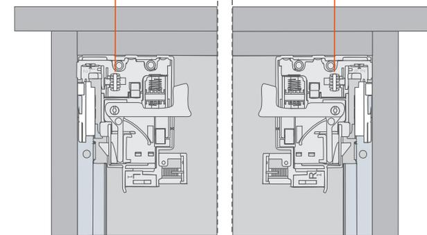
Aconselha-se fazer a regulagem lateral na mesma direção em ambos os clips para manter as corredejas paralelas e deslizantes. **ATENÇÃO**
