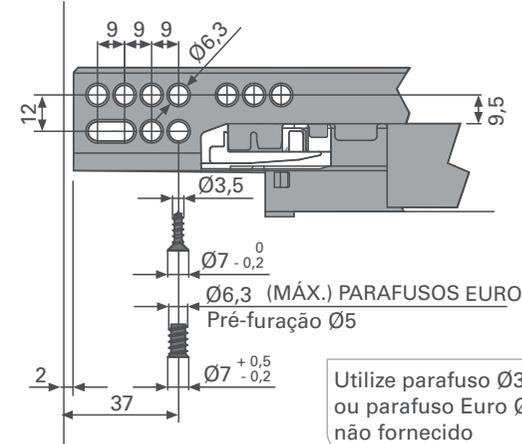
Utilize parafuso  $\varnothing 35 \times 14 \text{mm}$  ou parafuso Euro  $\varnothing 6,3 \times 14 \text{mm}$  não fornecido
