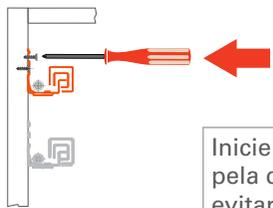
Inicie a montagem sempre pela corredeja superior para evitar que caia sujeira nas próximas a serem instaladas. **ATENÇÃO**
