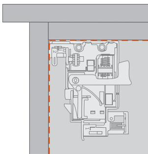
Posicione o clip na base da gaveta encostando na parte frontal e lateral dela.
