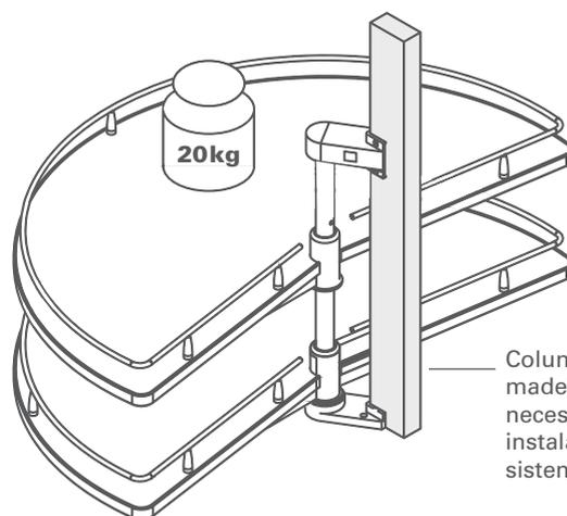
Coluna suporte em madeira 50x30 necessária para a instalação do sistema
