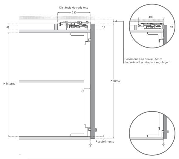
Altura da porta = Altura interna + Espessura da base + 44 + recobrimento do chapeu
