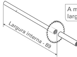
A medida de corte da barra é a largura interna do módulo - 89mm.
