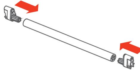
Encaixe as extremidade das barras de sincronização nas duas unidades de bloqueio já fixadas nas laterais do módulo.
