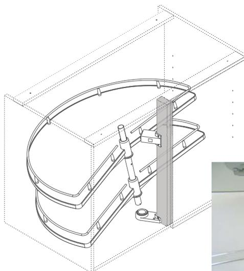
Encaixe todo o sistema previamente montado no suporte inferior no móvel.
