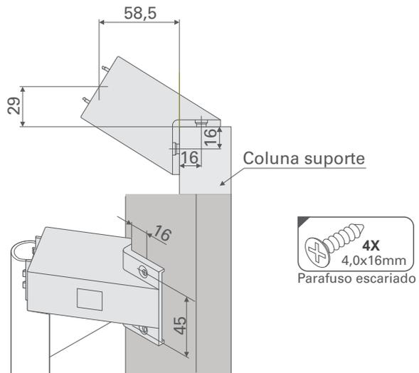
Montar a base de fixação superior na coluna suporte em função da altura do tubo.
