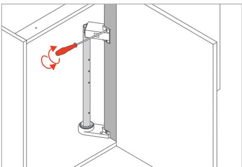
Para determinar a posição da base superior, encaixar o tubo de alumínio no suporte inferior.
