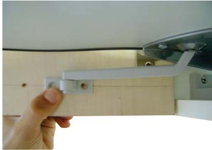
Com a porta aberta e o cesto inferior totalmente extraído, posicionar a base na linha de fixação na porta.
