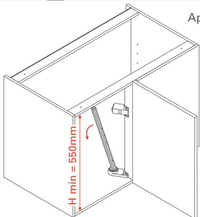
Após fixar a base superior, remova o tubo para a instalação dos cestos no módulo.
