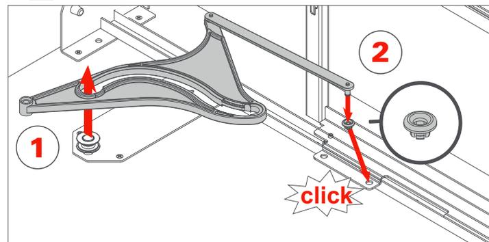
1 - Encaixe a parte vazada da guia de deslizamento na roldana da base fixada à guia traseira.
