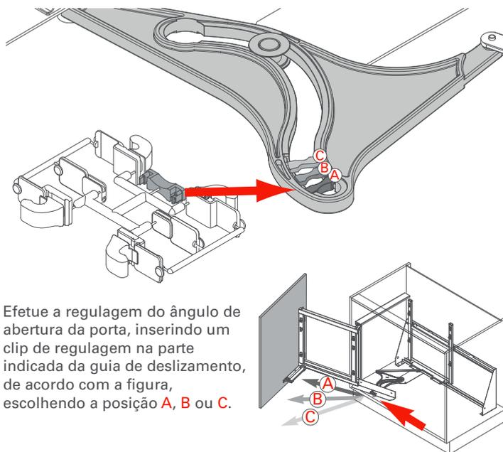
Efetue a regulação do ângulo de abertura da porta, inserindo um clip de regulação na parte indicada da guia de deslizamento, de acordo com a figura, escolhendo a posição **A**, **B** ou **C**.
