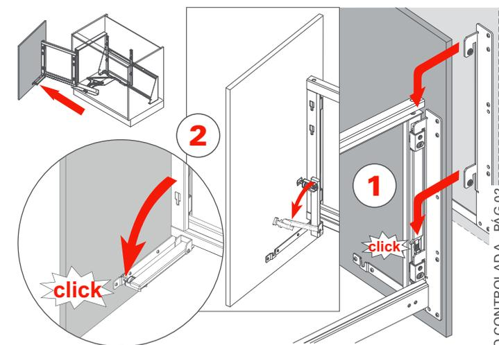
1 - Encaixe a parte lateral do quadro da porta no engate já fixado à porta, como indicado na figura.
