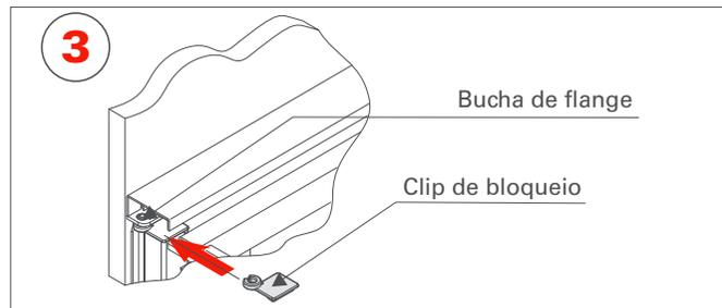
3 - Como garantia, pressionar a tampa de proteção com o clip de bloqueio integrado sob a bucha de flange.
