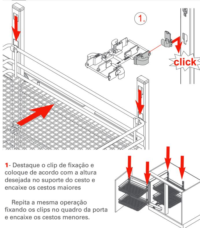
**1** - Destaque o clip de fixação e coloque de acordo com a altura desejada no suporte do cesto e encaixe os cestos maiores
