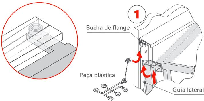
1 - Introduzir a estrutura deslizante ligeiramente inclinada na bucha de flange superior da guia lateral, prestar atenção para que o rolete da guia traseira permaneça dentro da guia.
