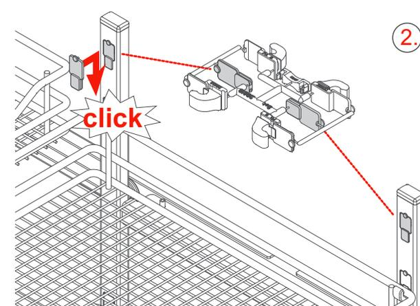
**2** - Destaque o tampa furos e encaixe nas aberturas que não foram utilizadas.
